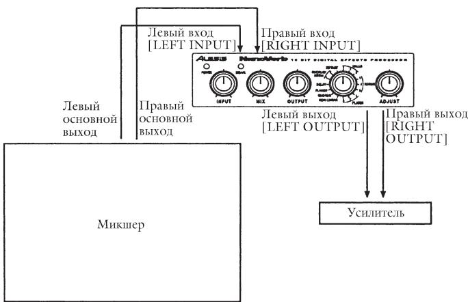
существенно улучшить качество обработки. Коммутация NanoVerb с таким пультом ничем не отличается от подключения прибора к обыкновенной консоли, за исключением одного очень важного момента:
